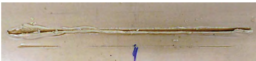
شکل ۴. سطح بیرونی لوله‌ی قطعه‌ای "inert"، که در زیر فشار بحرانی آزمون شده است و هیچ گونه آغاز ترک را نشان نداد. تیغه پرتاب شده، شیاری کوچکتر ایجاد کرد که آن هم محوری بود.
