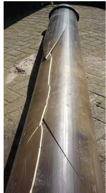
شکل ۱. (راست) لوله آب PVC پس از RCP. ترک در وسط ایجاد شده و سپس در دو جهت مخالف به حرکت درآمده. هر لوله دو شاخه یا سه شاخه شدن را نشان می‌دهد.
