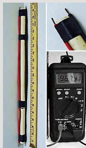
شکل ۱: ردیاب خاک. ساخته شده از لوله PVC قطر نیم اینچ، و سیم عایق شماره ۱۰ (چپ)، انتهای سیم لخت (بالا راست) و اهم‌متر (پایین راست)
