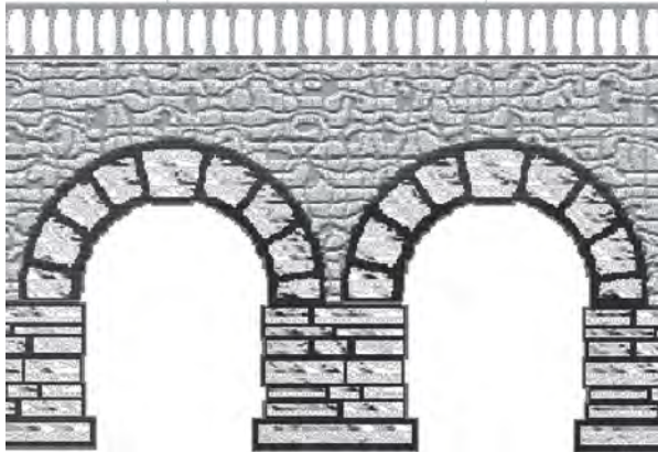
شکل ۸. شکل و مکان استقرار سنگ‌ها به طوری که از فرو ریختن قوس پل در روم باستان تا امروز جلوگیری می‌کرد.
